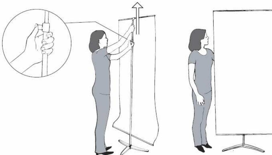
3. パネルの高さに合わせてポール(支柱)を伸ばします。
